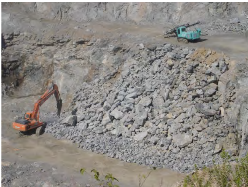
Foto 33 – Detalhe de operação de rompedor hidráulico na promoção de desmonte secundário de blocos de rocha, atuando após operação de desmonte primário em bancada na pedreira da Mineração Bruscato em São João da Boa Vista.
