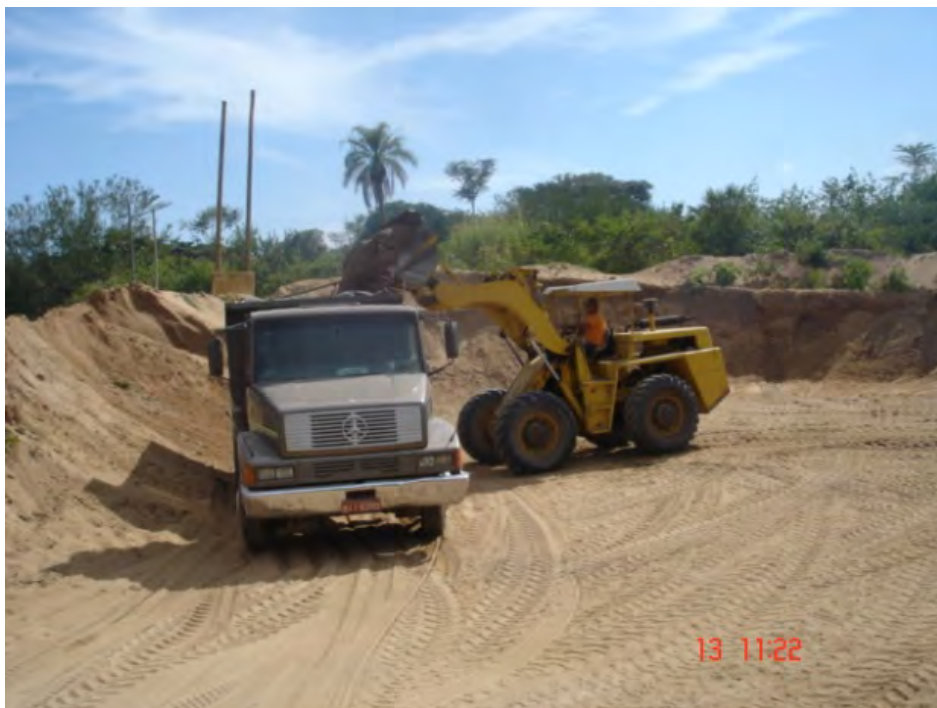
Foto 54 – Operação de carregamento de areia extraída no leito do rio Jaguari Mirim da Mineração Sardelli em São João da Boa Vista.
