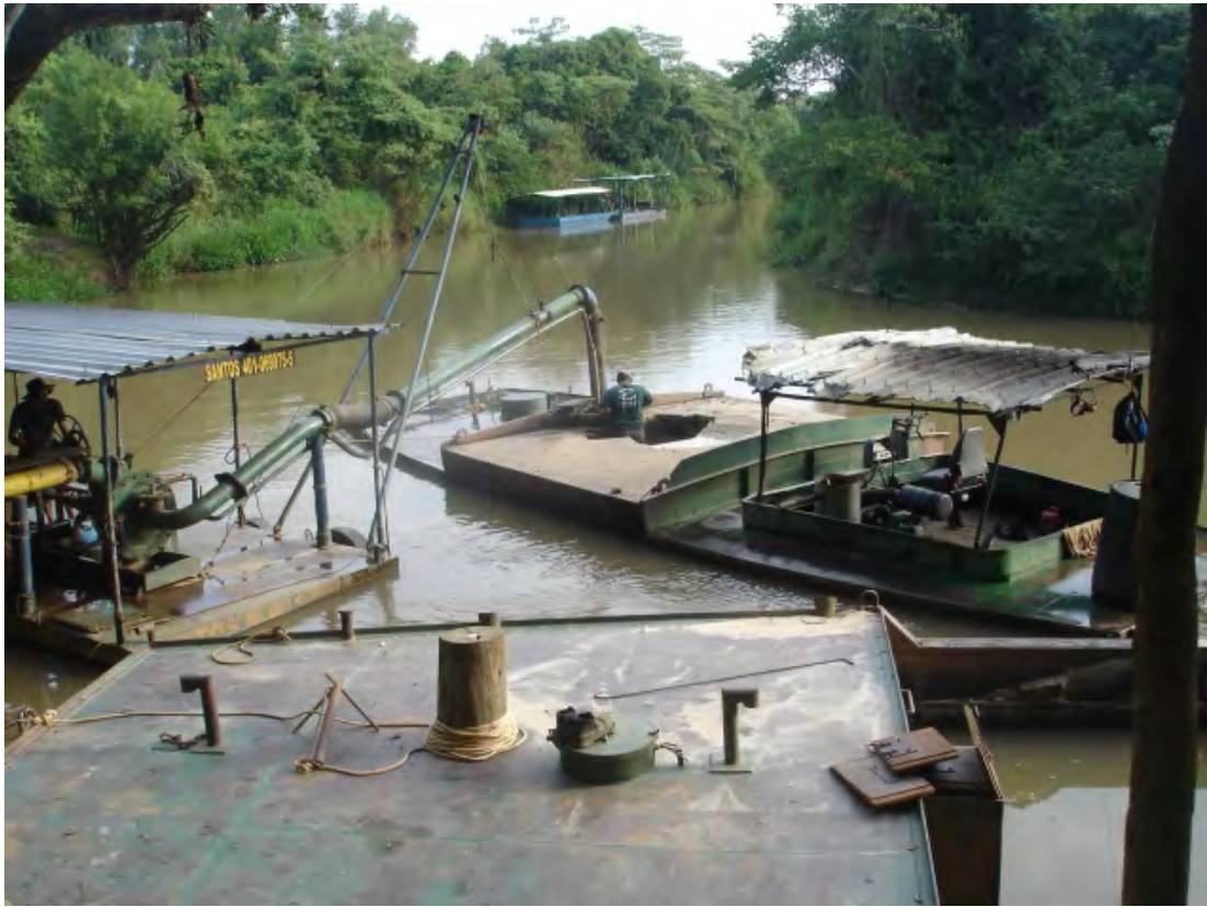
Foto 48 – Equipamentos de dragagem em leito de rio montados sobre barcaças no rio Jaguari-Mirim da Mineração Jaguari em Aguaí.
