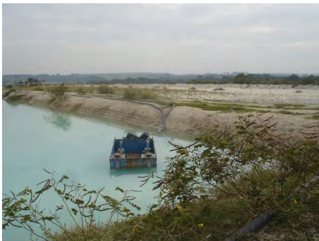
Foto 45 – Vista parcial do tanque de decantação de finos em área anteriormente minerada de argilito e areia na Mineração Santa Luzia em Aguai.
