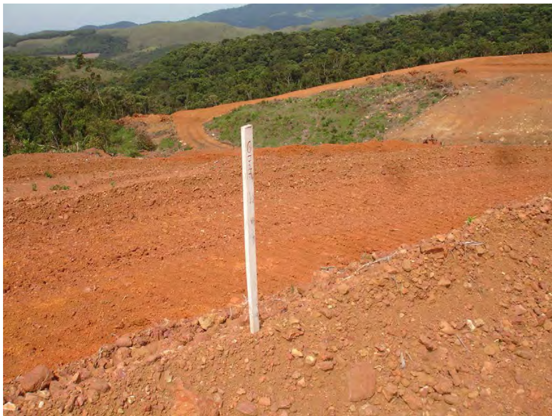
Foto 7 - Estaca número 677 indicativa de furo de sondagem com informações da pesquisa mineral.
