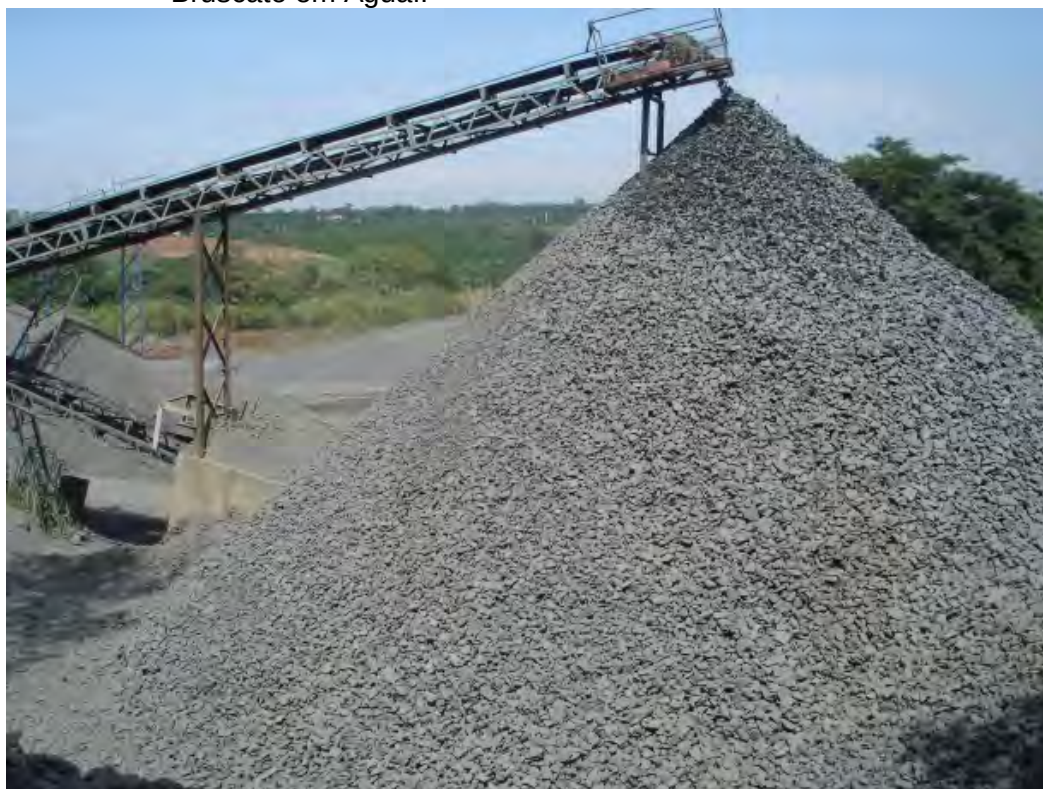
Foto 38 – Formação de pilha de estocagem de brita classificada na pedreira da Mineração Bruscato em Aguai.
