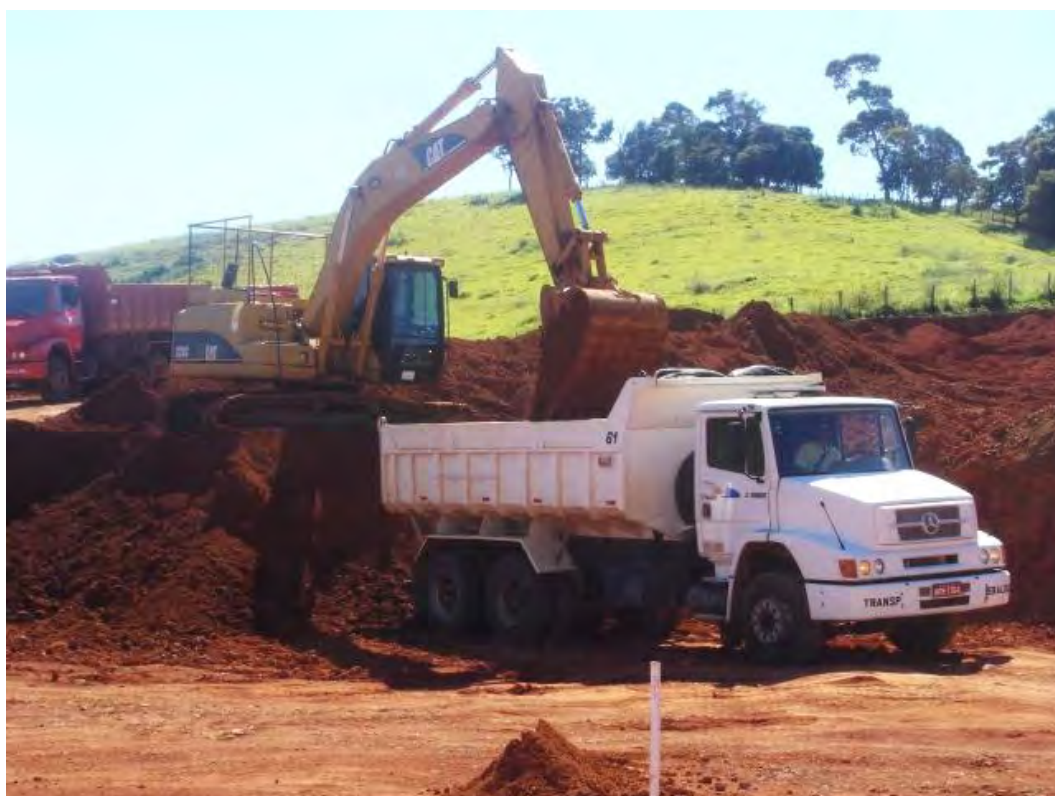
Foto 28 – Operação de carregamento de minério de bauxita em área de lavra da CBA em Divinolândia.
