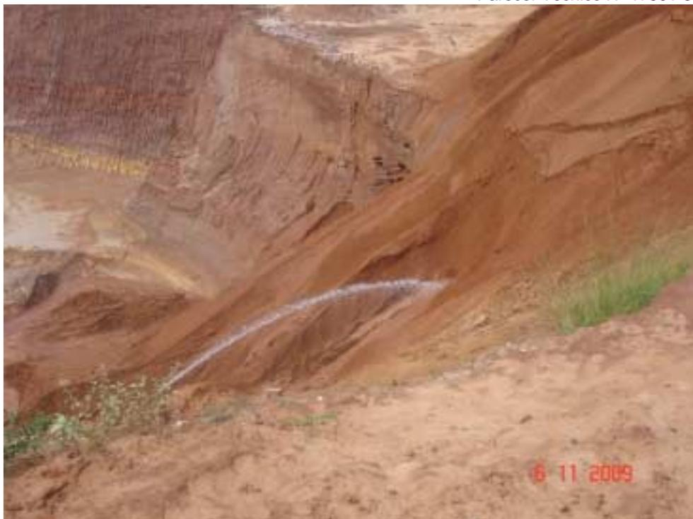
Foto 12– Exploração de areia com desmonte hidráulico nos sedimentos da Formação Pirambóia na parte centro-leste do município. Pto 024PAB.
