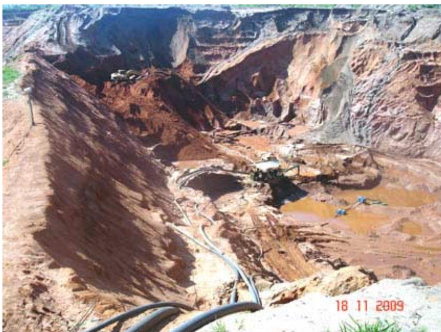
**Foto 16** – Aspecto da cava de exploração de areia do Porto de Areia Extrabase, onde a draga ao centro dá uma noção de escala.
