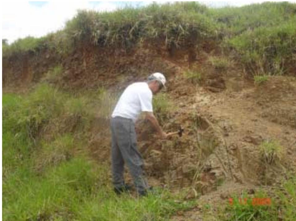
**Foto 13** – Afloramento de basalto alterado com utilização em pavimentos de estradas vicinais.
