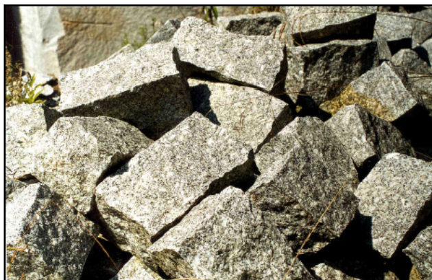
Foto 27 – Paralelepípedo, principal produto comercializado pelos canteiros.
