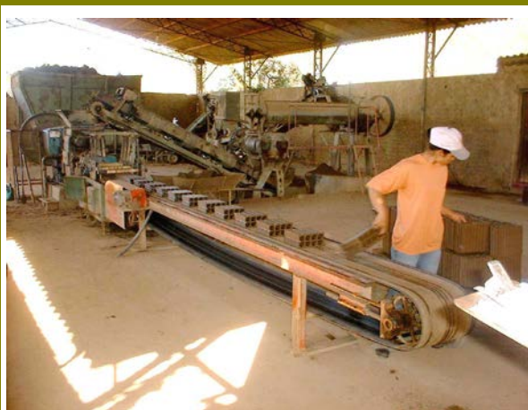
96 – Confeção dos tijolos.
