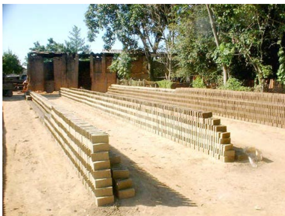
72 – Secagem a céu aberto e fornos tipo caipira ao fundo.
