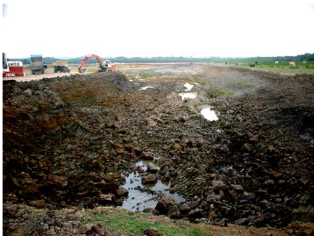
Foto 11 - Local de avanço da lavra de argila por meio de escavação em tiras contíguas ( Barreiro da Cerâmica Rincão).
