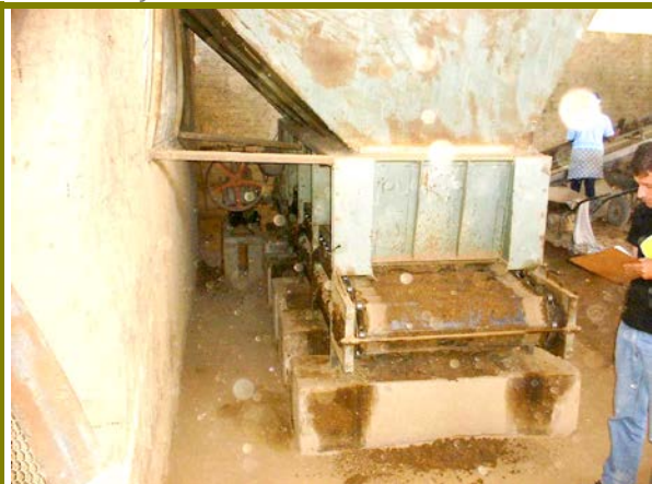
90 – Esteira metálica que regula a quantidade de argila.
