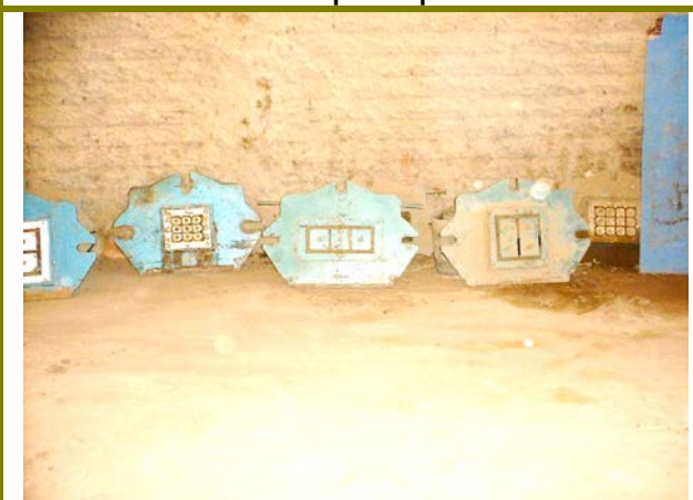
101 – Tipos de boquilhas para a produção de diferentes peças.
