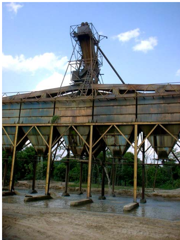
Foto 2 - Sistema de classificação e de transferência da areia para silos de estocagem (Mineração Carrera).
