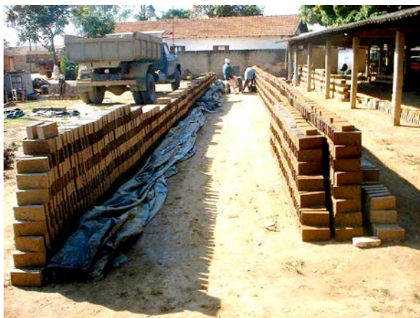
71 – Pátio de secagem com cobertura parcial.
