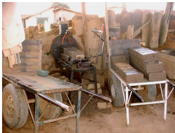
21 - Extrusora para fabricação de tijolo liso.
