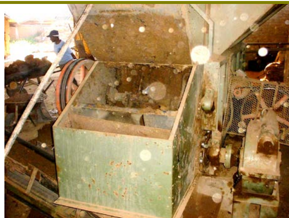
91 – Detalhe do facão para quebrar os grandes torrões.
