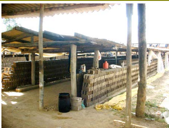
79 – Secagem dos tijolos em galpão coberto.
