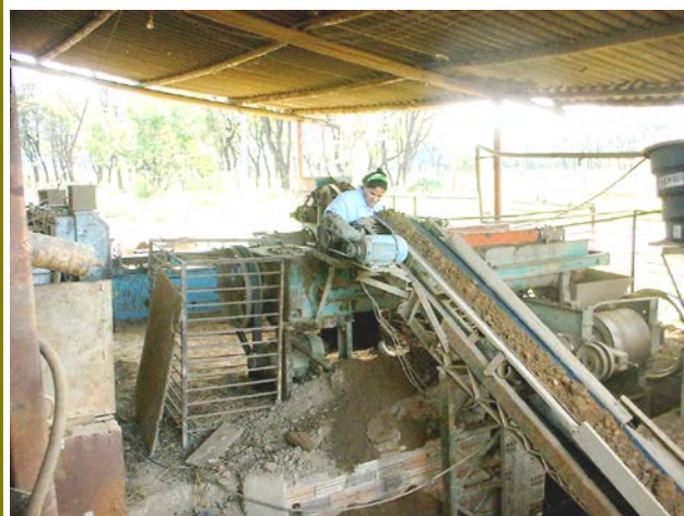
50 – Cilindro, misturador e extrusora (atrás) para fabricação de tijolo baiano.
