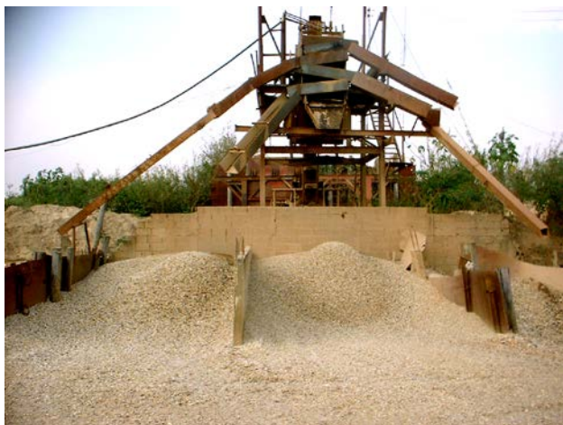
Foto 9 - Instalações de classificação do cascalho visando sua comercialização (Mineração São Carlos).
