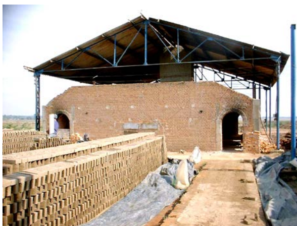
28 – Forno tipo abóboda e pátio de secagem.
