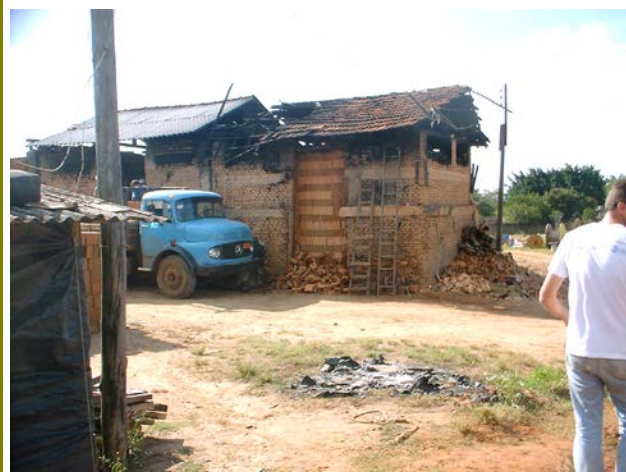
56 – Carregamento de tijolos baianos após queima.
