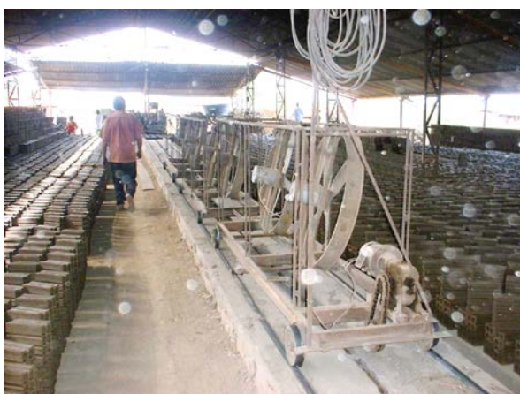
51 – Ventilação artificial para secagem dos tijolos em pátio coberto.
