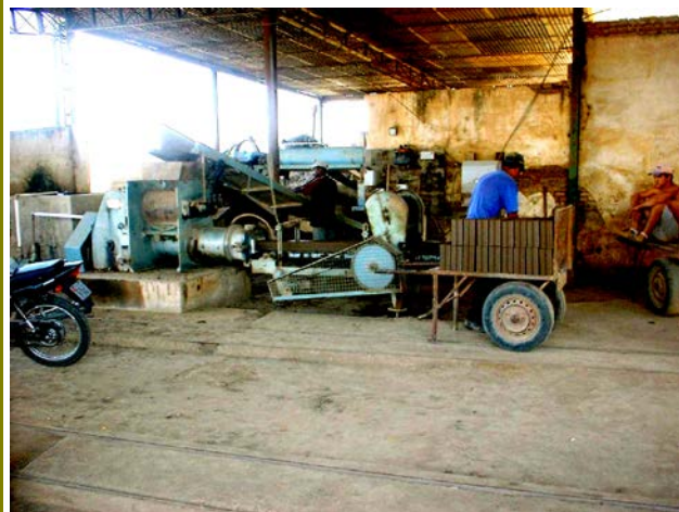
46 – Laminador, misturador e extrusora para fabricação de tijolo baiano.
