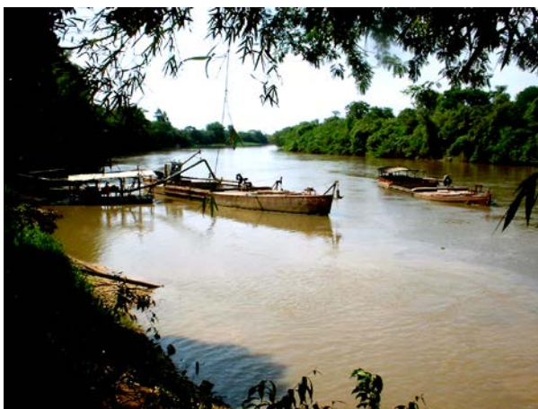
Foto 1 - Operação de bombeamento de polpa para transferência de areia dragada no leito do rio Mogi Guaçu (Mineração Carrera).
