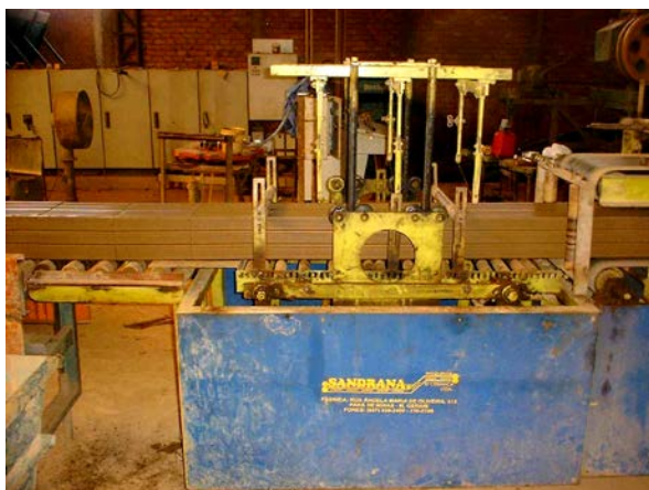
07 – Corte automático dos tijolos.
