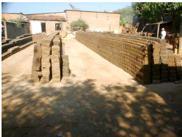
76 – Secagem dos tijolos a céu aberto.
