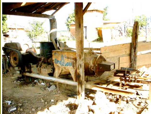
60 – Extrusora para fabricação de tijolo liso.
