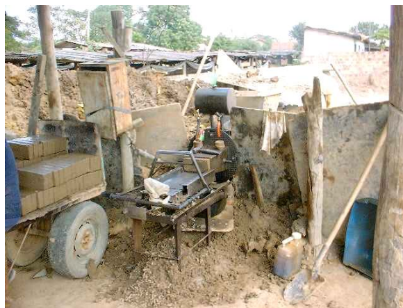
87 – Extrusora para fabricação de tijolo liso.
