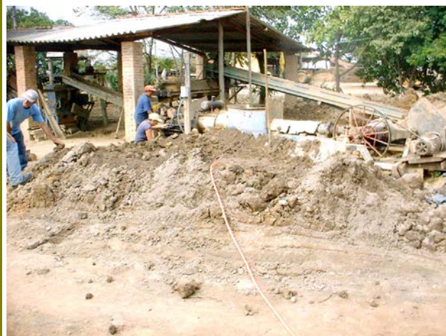
84 – Alimentação manual em cilindro, misturador e extrusora para fabricação de tijolo liso.
