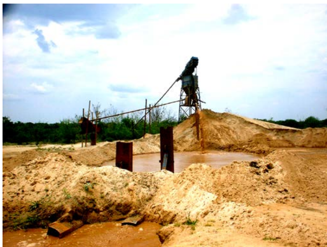
Foto 5 - Instalação de classificação e lavagem de areia (Mineração Uirapuru).
