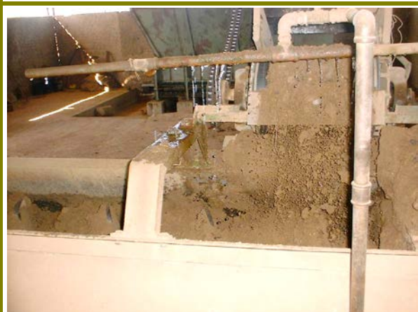
94 – Triturador e misturador.
