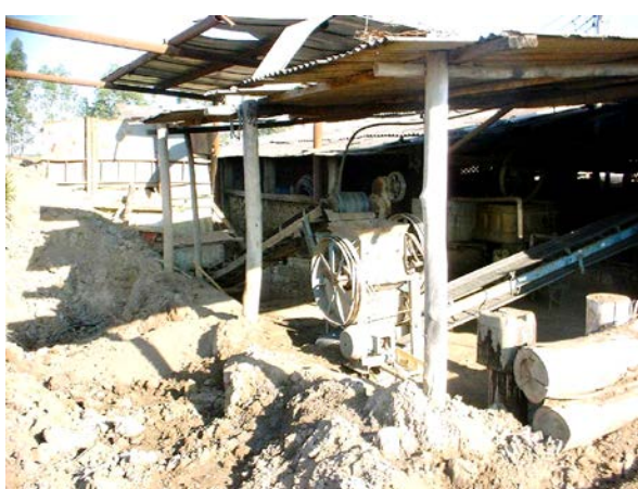
16 – Extrusora para fabricação de tijolo liso.
