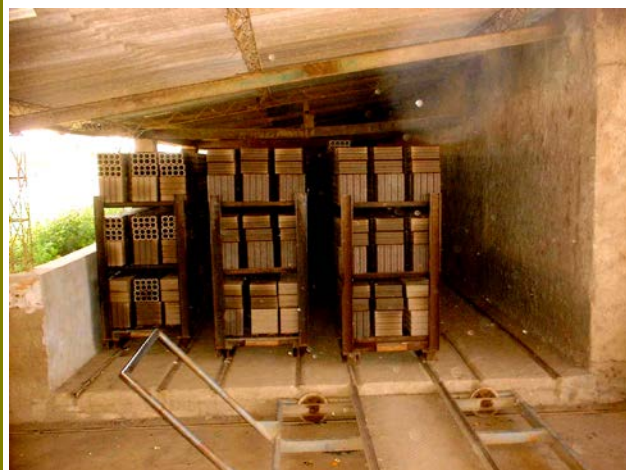
48 – Carrinhos para transportar tijolos para secagem em estufa.
