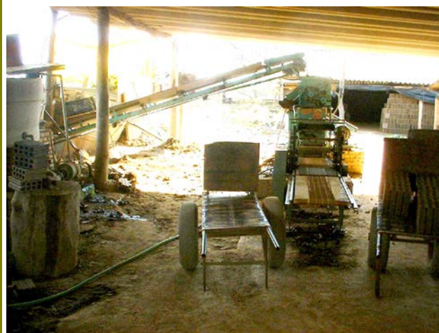
54 – Extrusora para fabricação de tijolo baiano.
