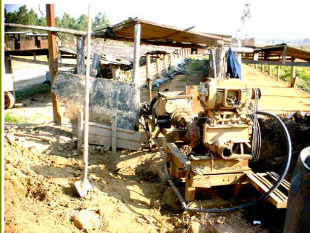
42 – Extrusora para fabricação de tijolo cavado e pátio de secagem ao fundo.
