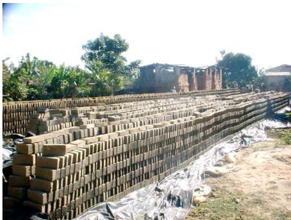
67 – Secagem a céu aberto e fornos tipo caipira ao fundo.
