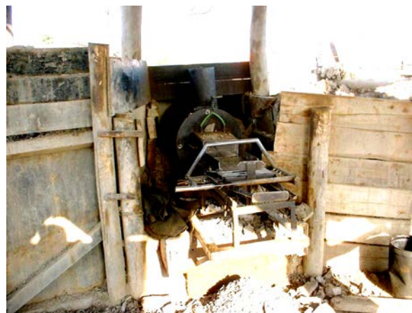
44 – Extrusora para fabricação de tijolo liso parada.
