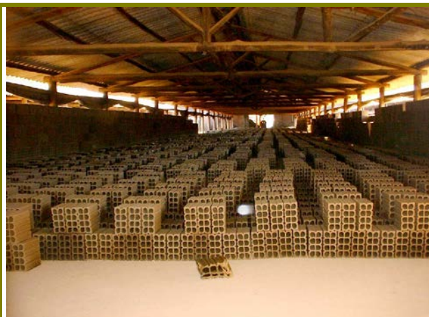
97 – Galpão para secagem.
