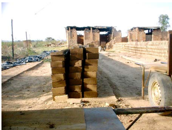
65 – Secagem a céu aberto e fornos tipo caipira ao fundo.
