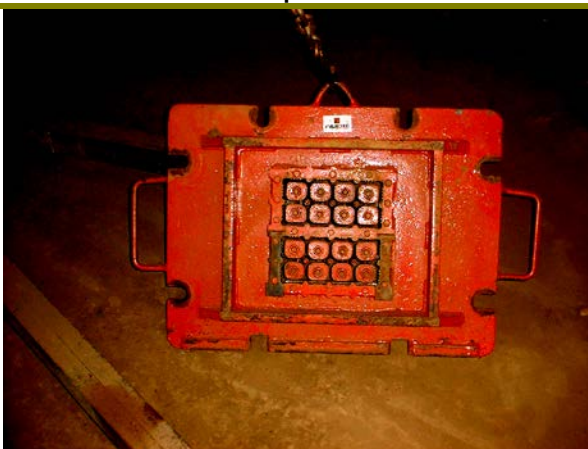
12 – Boquilha para fabricação de tijolo baiano 8 furos.
