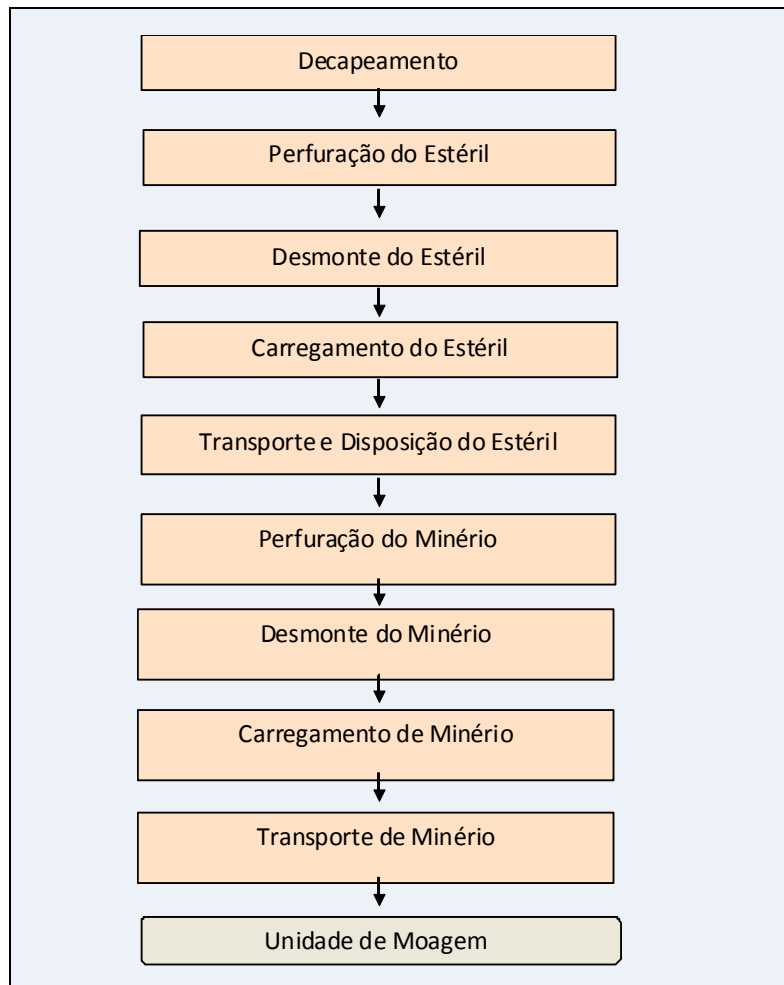
Figura 31 - Fluxograma das operações de lavra e beneficiamento do calcário dolomítico.
